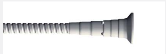
Prut s kotvní úpravou pomocí kotvní hlavice.
